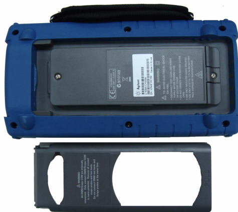
Figure 8-2 Démontage de la béquille de l'instrument
