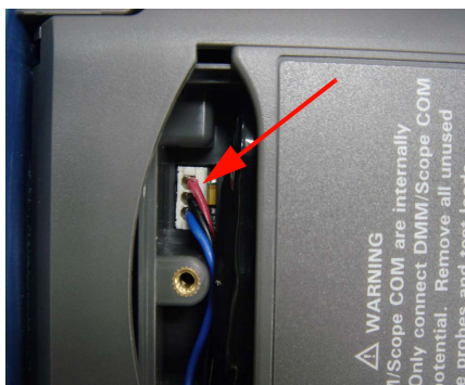
Figure 8-6 Débranchez le connecteur à trois fils à l'aide de pinces brucelles.
