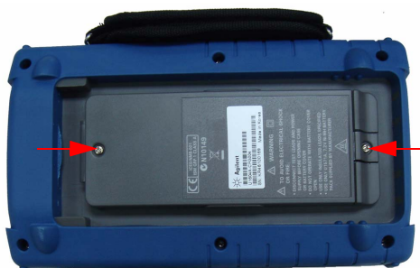
Figure 8-3 Dépose des vis du couvercle du compartiment de la batterie
