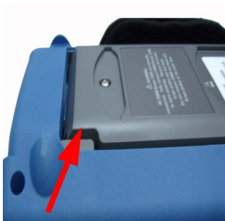
Figure 8-1 Pression à exercer dans le sens de la flèche pour le démontage de la béquille
