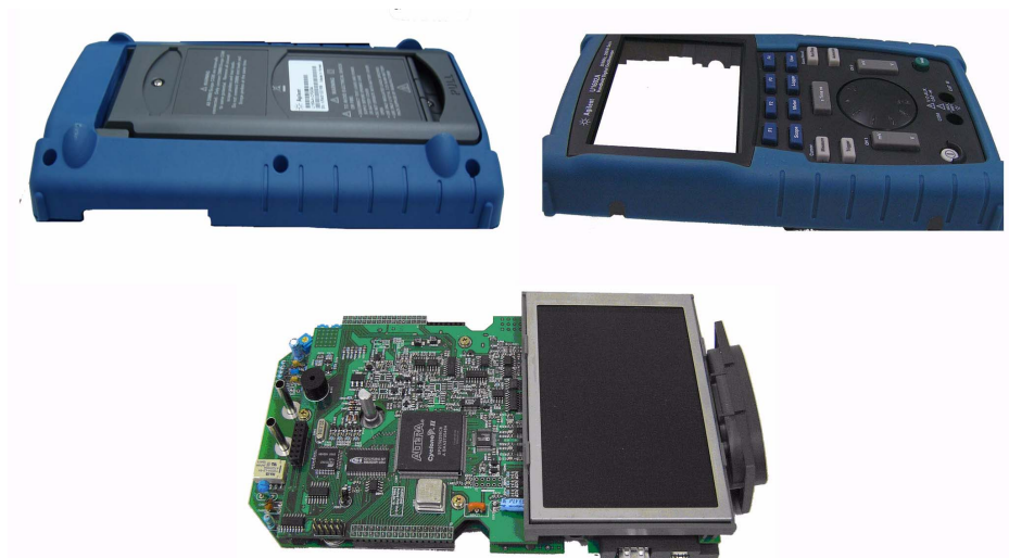
Figure 8-10 Démontage des capots avant (à droite) et arrière (à gauche) de la carte à circuit imprimé de l'instrument
