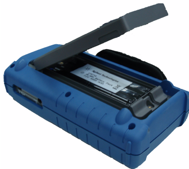
Figure 8-5 Dépose du couvercle du compartiment de la batterie sans démontage de la béquille
