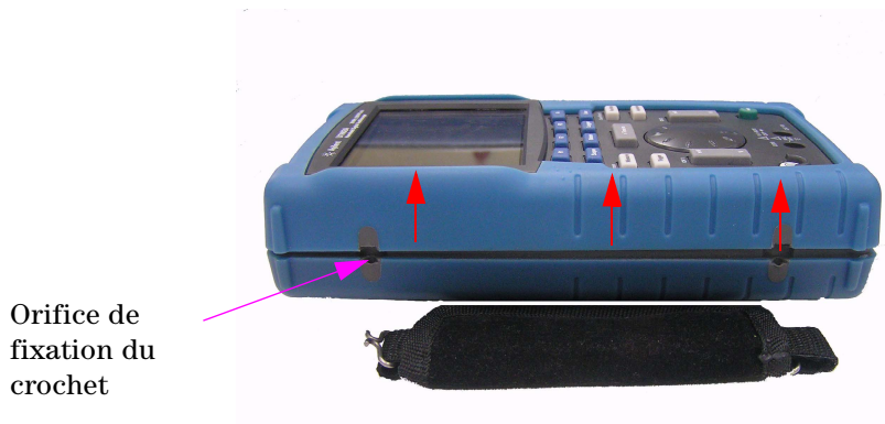
Figure 8-8 Démontage de la poignée de l'instrument
